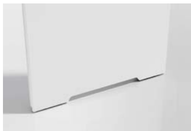
PODCIĘCIE WENTYLACYJNE W DRZWIACH PŁYTOWYCH 1 podcięcie 15 mm – do pomieszczeń z rekuperacją podcięcie 26 mm – WC dla drzwi 80'-100' podcięcie 38 mm – WC dla drzwi 60'-70'
