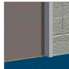
2. Miejsce łączenia podłóg oraz przesunięcie skrzydła po zamontowaniu ościeżnicy CMOK.
