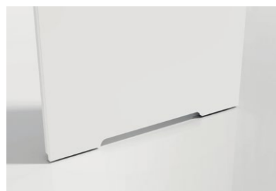
PODCIĘCIE WENTYLACYJNE W DRZWIACH PŁYTOWE* podcięcie 15 mm – do pomieszczeń z rekuperacją podcięcie 26 mm – WC dla drzwi 80'-100' podcięcie 38 mm – WC dla drzwi 60'-70'
