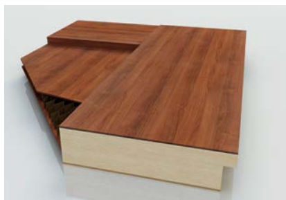
door leaf cross-section сечение дверного полотна
